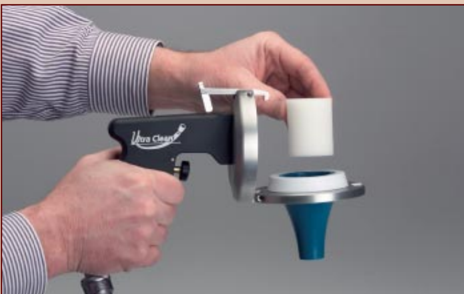
Afbeelding 3. Het plaatsen van een projectiel in het lanceerpistool.
